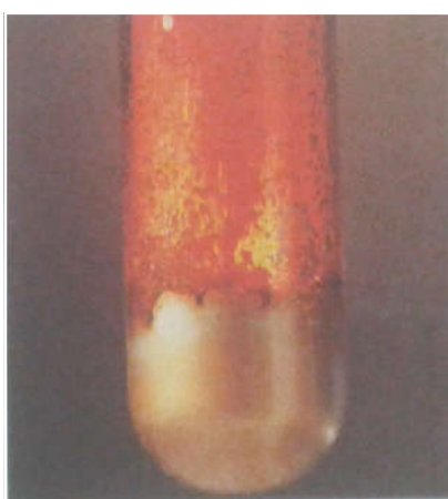
Fig. 3. Réaction entre le dibrome et l'aluminium. On laisse tomber quelques gouttes de dibrome liquide Br_2 sur de l'aluminium en poudre ; on observe alors de vives incandescences. Il y a formation de tribromure d'aluminium AlBr_3
